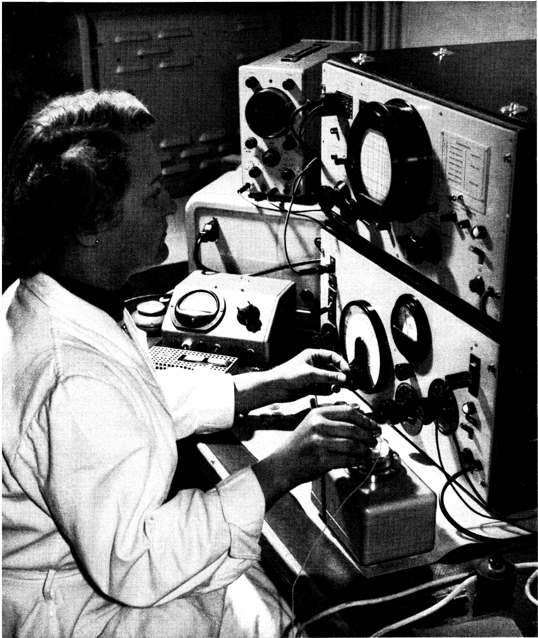
Ein Beispiel für den Einsatz von Nachrichten-Meßgeräten in Nachbargebieten: Rasches und doch sorgfältiges Durchmessen jeder Hörkapsel für Schwerhörigengeräte mit einem Meß- platz aus Tonfrequenz-Pegelsender, Pegelbildempfänger und OSCILLARZET
