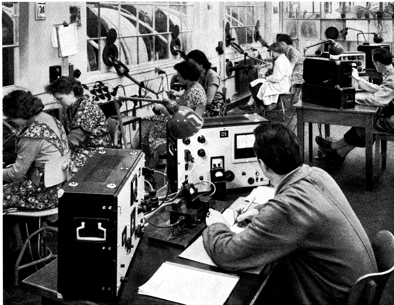
Einsatz von TF-Meßplätzen in einem Prüffeld für Trägerfrequenz-Weitverkehrskabel
