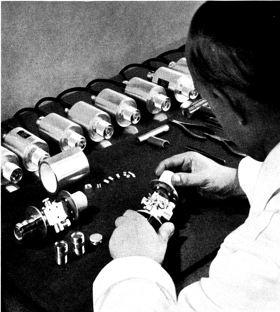
Zusammenbau der Meßköpfe des Spannungsmessers
